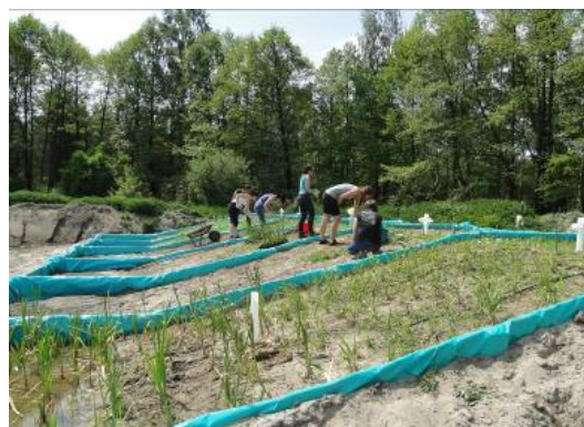
Fot. Budowa systemów modelowych w Stacji Terenowej (a); nasadzenia roślinności w ukształtowanych systemach z zamontowaną siecią piezometrów (b), wiosna 2011
